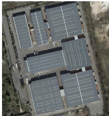
Figura 77. Esempi di tetti fotovoltaici (circa 5 ettari), comune di Tivoli (Roma). Impianto da oltre 4,2 MW
